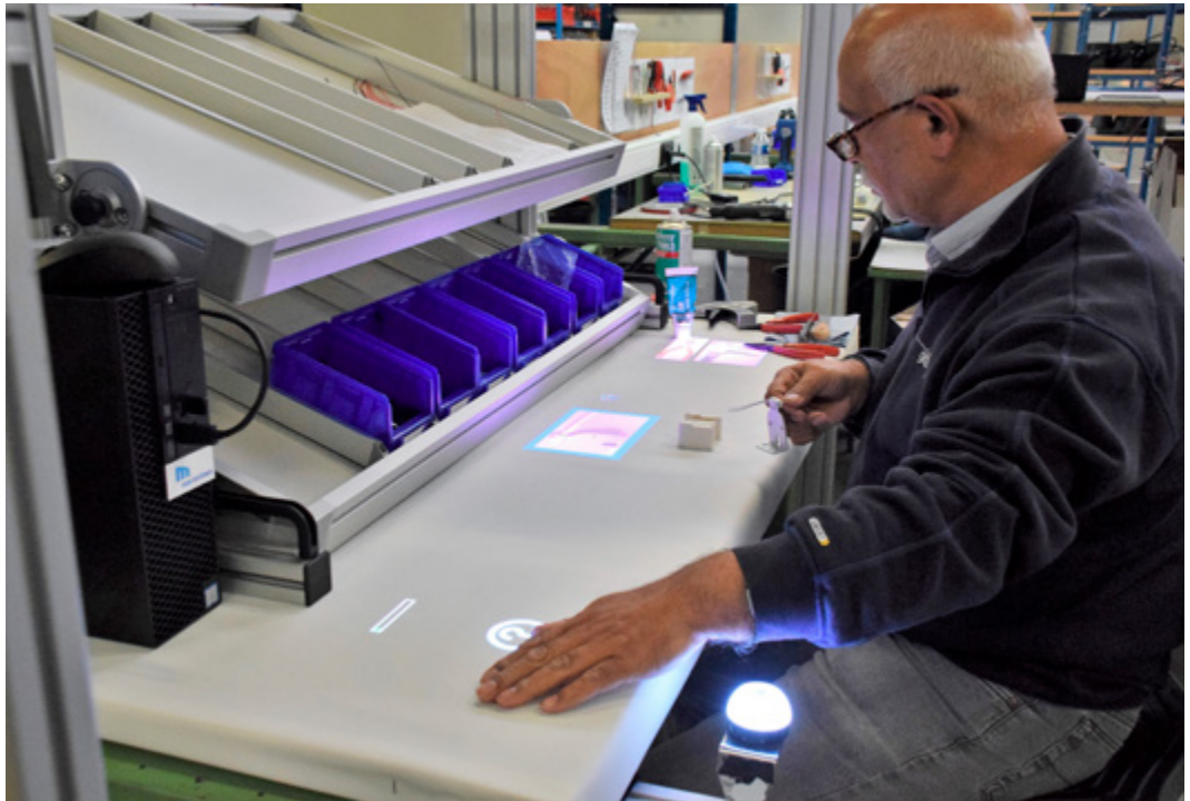
Mariasteen zet Light Guide Systems in op verschillende activiteiten en werkposten op de werkvloer.
